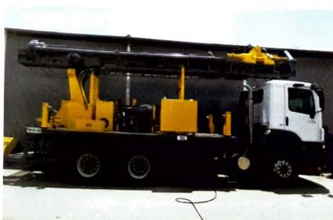
**Projeto compacto exclusivo** - Um dos grandes diferenciais da Epiroc TH10LM, está em seu *design* inovador sem projeção traseira com a torre baixada. A sonda quando em modo de transporte não desenvolve balaço traseiro, ou seja, permite uma circulação muito mais segura a qualquer hora do dia ou da noite.
