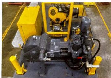
**Conceito modular** - A abordagem modular da TH10LM garante que o equipamento seja facilmente adaptável a mudanças, mesmo após a compra. A sonda possui a capacidade *plug-and-play*, ou seja, o cliente pode facilmente adicionar ou remover componentes, comprar kits conforme desejar. Além disso, esse recurso permite montar a sonda em caminhões de diferentes configurações.
